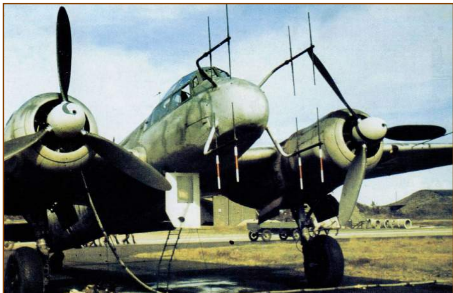
De Junker Ju 88 nachtjager met radarantenne en het embleem van het NJG 3
